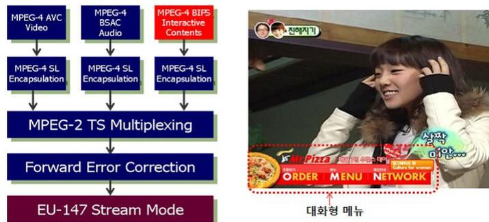
(그림 62) 지상파 DMB 다중화 및 BIFS 서비스 화면 예시
