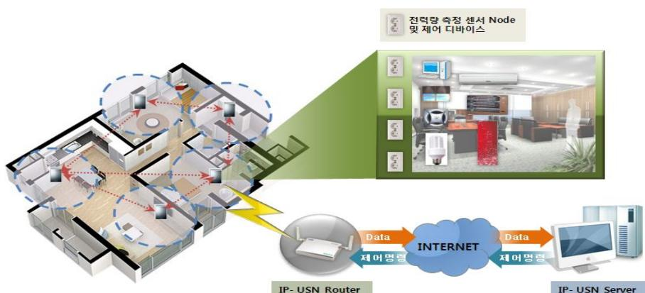
[그림 4-2-4] IP-USN기반의 전력 측정 개념도
