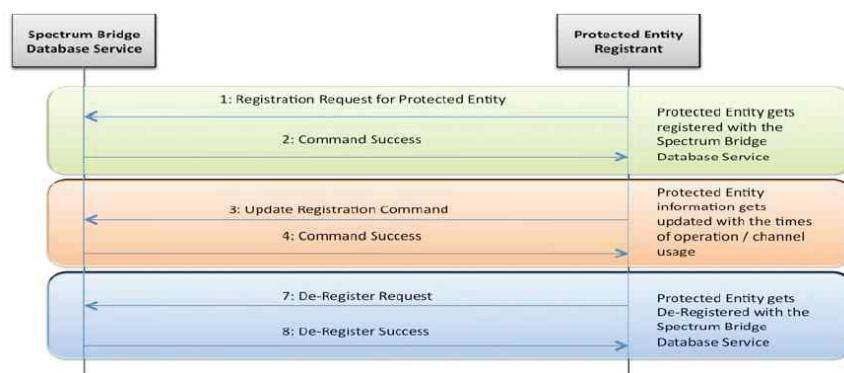
[그림 5-4] Spectrum Bridge Inc.의 시스템 구조 및 인터페이스
