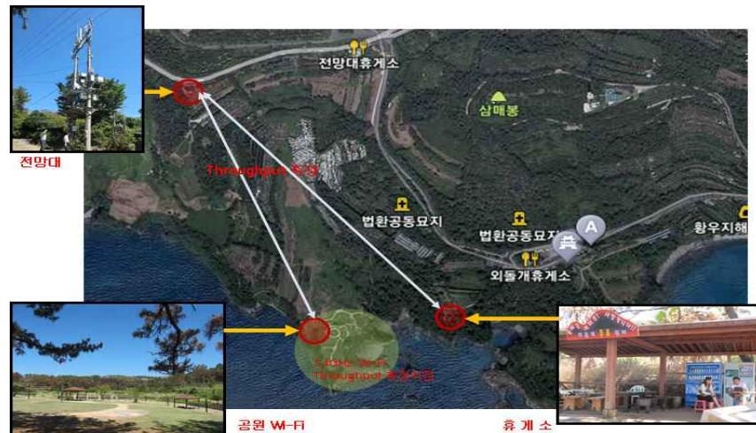
TV 유휴대역 AP 지점은 [그림 6-2]과 같이 TVWS AP(송신지점)에 설치 될 예정이며, 이곳에서, TV 유휴대역 CPE를 나타내는 TVWS CPE 1, 2 지점까지 580 ~ 600M이상 이격이 되어 있다. 테스트는 간섭이 많이 일어 날 것 같은 지역인 TVWS CPE2 지점부터, LOS가 확보가 되는 지점인 TVWS CPE1까지 스펙트럼으로 이용하여 주변 간섭 채널 여부 확인 및 RSSI 값 및 Throughput 측정으로 서비스 가능 여부를 판단 할 것이다.
