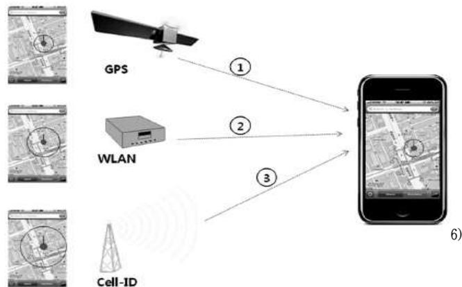
플랫폼 단은 앞서 살펴본 위치를 측정하는 하드웨어와 위치를 이용해 서비스를 제공하는 응용 프로그램 간의 매개 역할을 수행한다. 위치를 측정하는 하드웨어를 관리하면서, 응용프로그램이 현재 위치를 요청할 경우 측위 하드웨어를 통해 그 결과를 알려준다.
