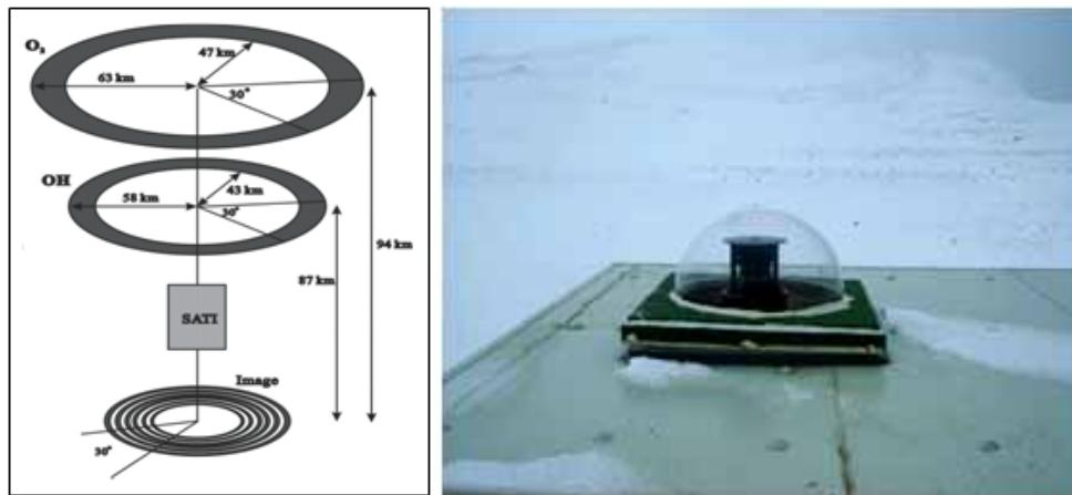
그림 1-40 SATI 관측 개요도(좌)와 관측 준비 상태(우)
