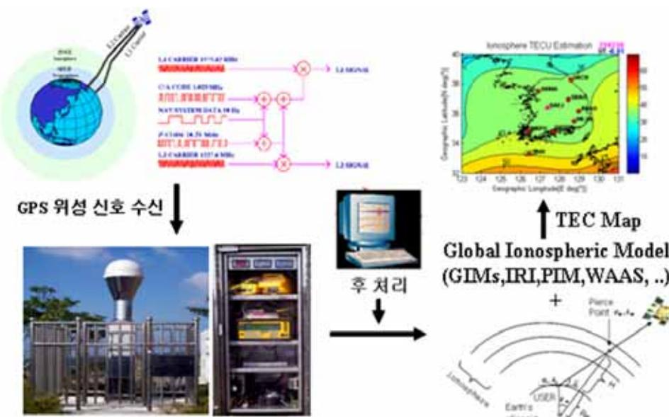
그림 3-9 전리층 전자밀도 관측 시스템 모식도
