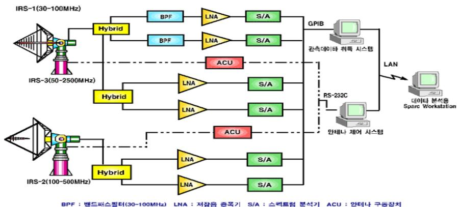
그림 3-4 태양전파 관측시스템 및 자료처리 구성도
