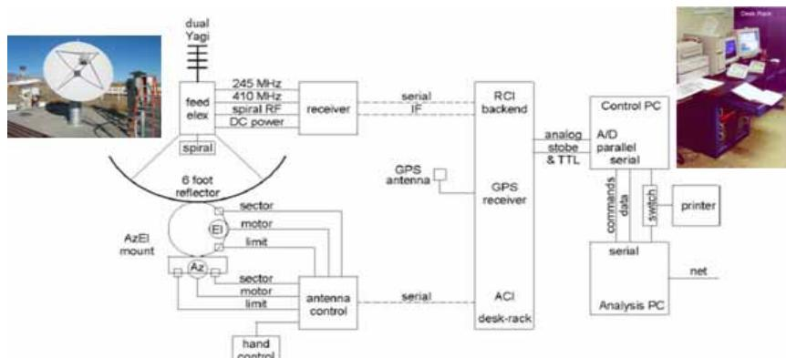
그림 3-6 태양전파 스펙트럼 분석 시스템 구성도
