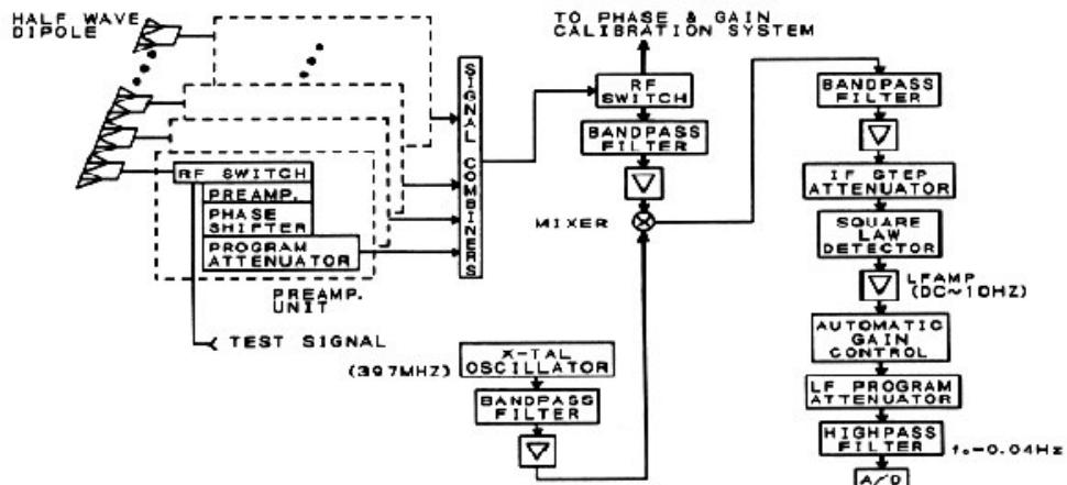
그림 3-17 IPS 안테나 수신신호 처리 개요도
