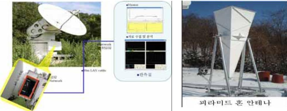
그림 3-5 2.8GHz 태양전파 수신시스템
