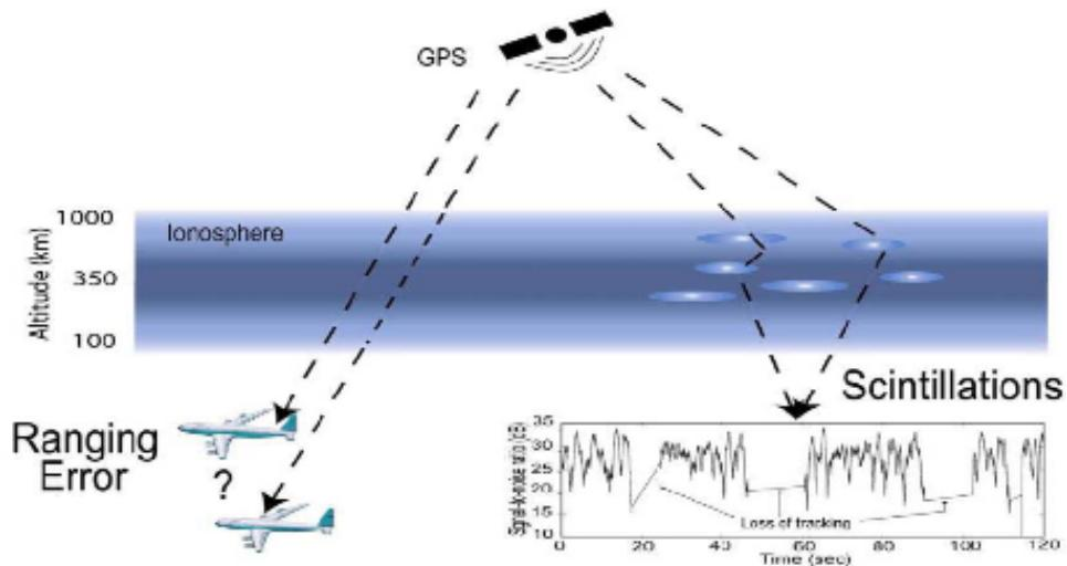
그림 1-6 GPS 수신신호의 에러발생 예시
